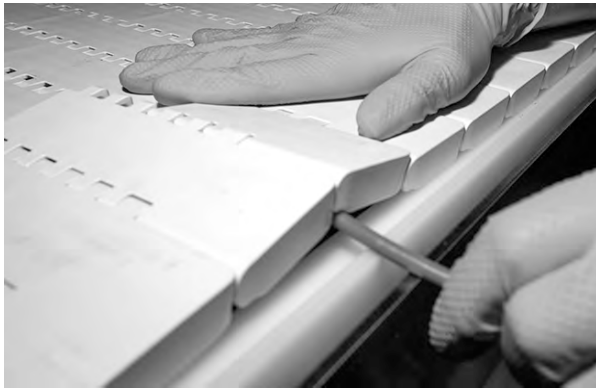
Figuur 88: De scharnierpen een beetje buigen en in de scharnieren steken
