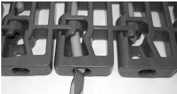
Figuur 123: Duw de scharnierpen tot in de scharnierpenborging
