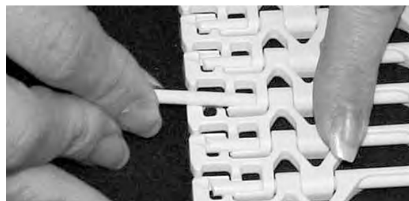
Figuur 169: De scharnierpen in de scharnieren steken
