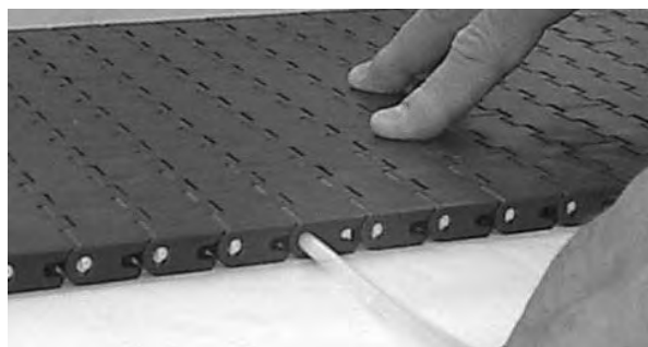
Figuur 161: Breng de scharnieren in
