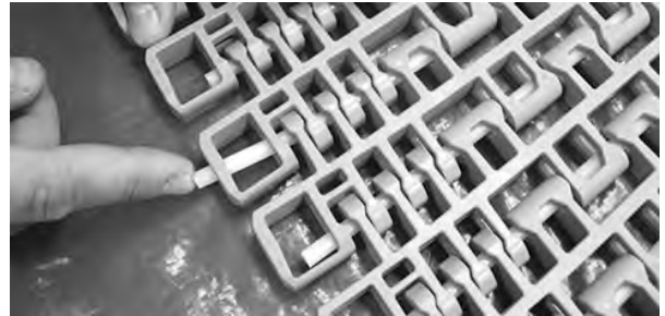
Figuur 338: Duw de scharnierpen tot in de scharnierpenborging
