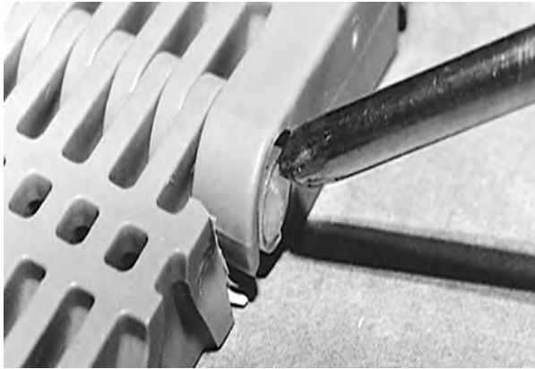
Figuur 48: De scharnierpen tot in de scharnierpenborging duwen
