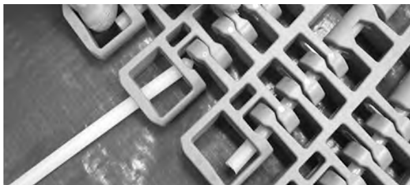
Figuur 337: De scharnierpen in de scharnieren steken
