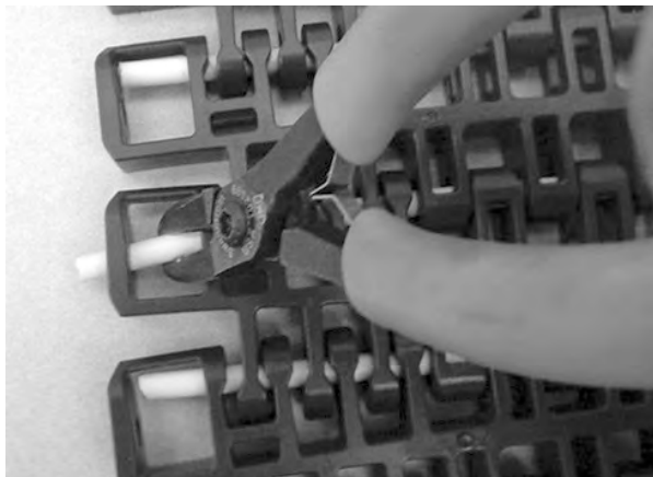
Figuur 357: Duw de scharnierpen tot in de scharnierpenborging
