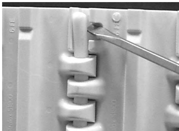
Figuur 206: Scharnierpen uit scharnierpenborging verwijderen
