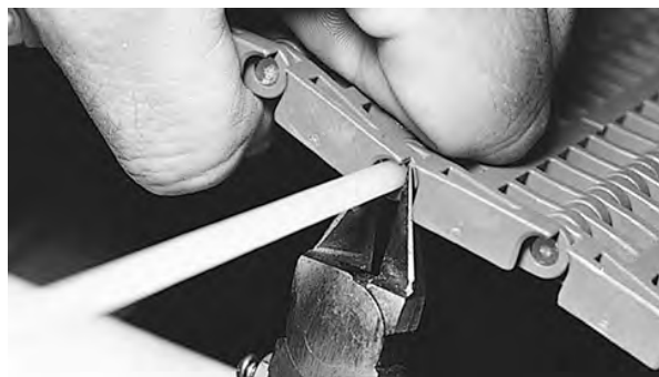
Figuur 113: De scharnierpen snijden zodat deze op gelijke lijn ligt met de rand van de band
