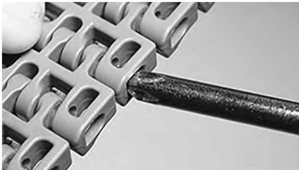
Figuur 145: Duw de scharnierpen tot in de scharnierpenborging
