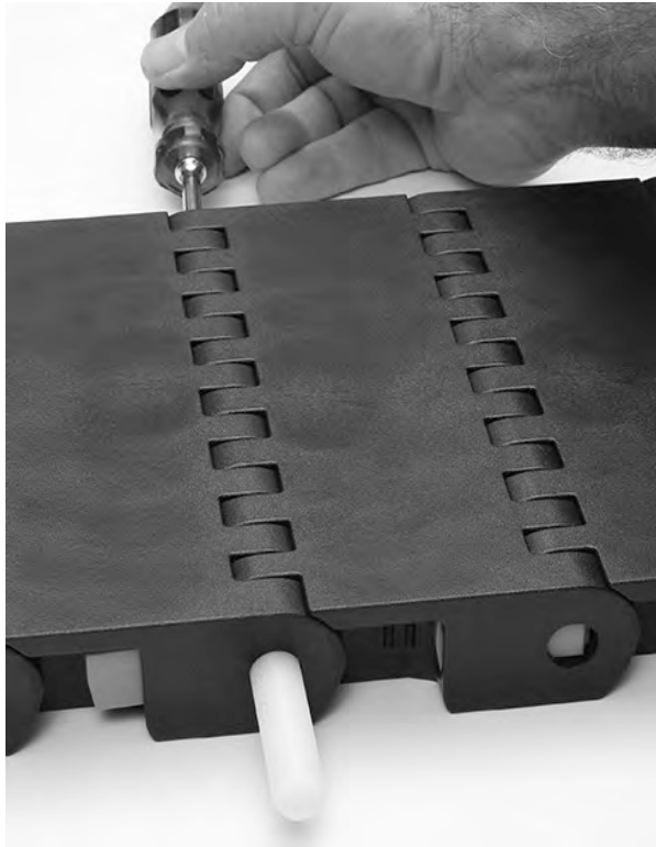
Figuur 259: De scharnierpen uit de band duwen
