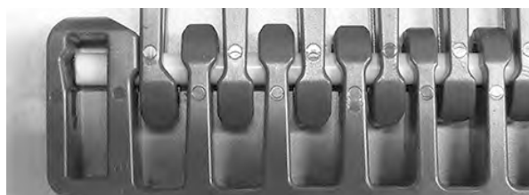
Figuur 332: Controleren of de scharnierpen in de scharnierpenborging zit
