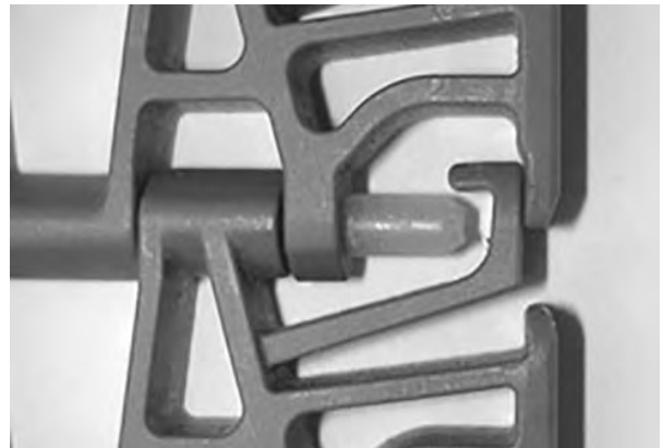
Figuur 248: Controleren of de scharnierpen in de scharnierpenborging zit
