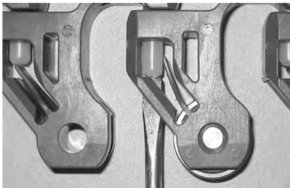
Figuur 278: Duw de scharnierpen tot in de scharnierpenborging
