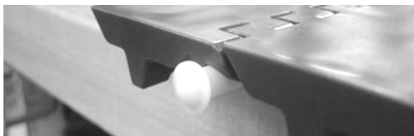
Figuur 96: De scharnierpen in de scharnieren steken
