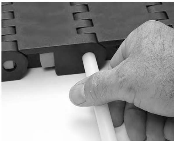
Figuur 261: Breng de scharnierpen in
