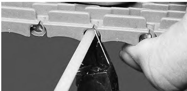
Figuur 24: De scharnierpen snijden zodat deze op gelijke lijn ligt met de rand van de band
