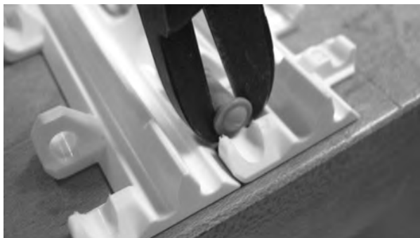
Figuur 182: De kop van de scharnierpen snijden
