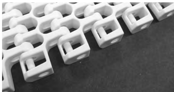
Figuur 289: Controleren of de scharnierpenen in de scharnierpenborging zit
