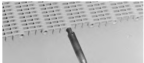
Figuur 30: De scharnierpenopening sluiten
