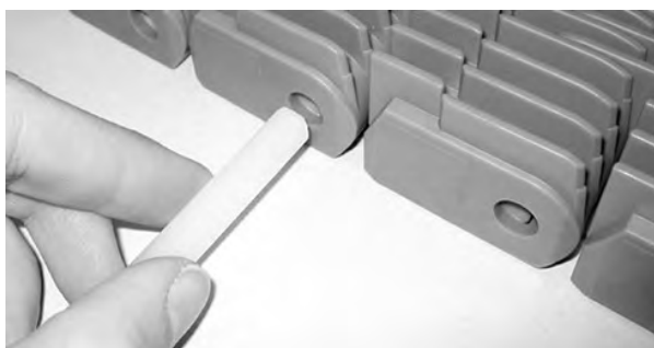
Figuur 215: De scharnierpen in de scharnieren steken
