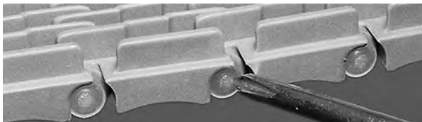
Figuur 23: De kop van de scharnierpen voorbij het snapslot duwen
