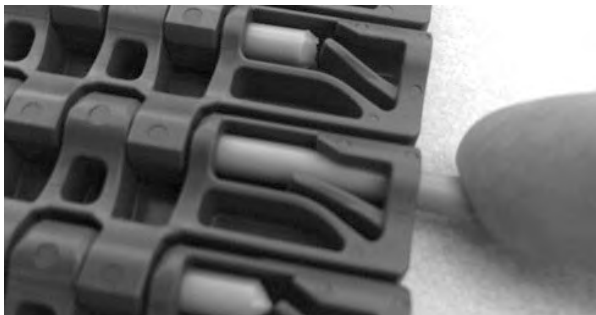
Figuur 127: De scharnierpen in het scharnier steken
