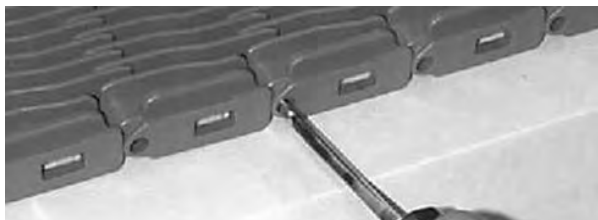
Figuur 44: De scharnierpen uit de band duwen
