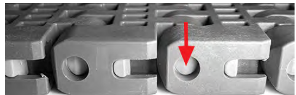
Figuur 155: Controleren of de Slidelox open is
