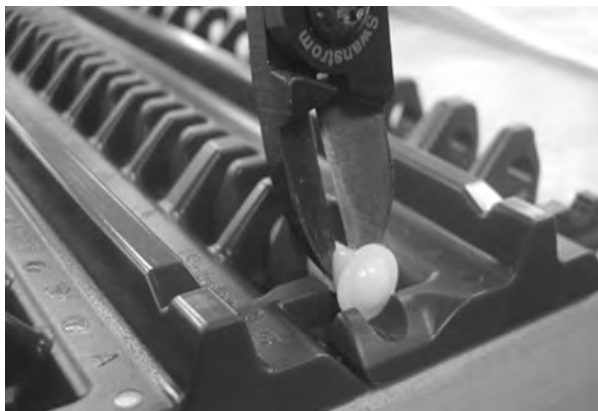
Figuur 71: De kop van de scharnierpen snijden
