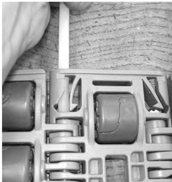
Figuur 221: De scharnierpen uit de band duwen
