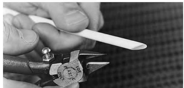
Figuur 14: Scharnierpen schuin afknippen
