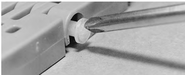
Figuur 37: De scharnierpen in de band duwen
