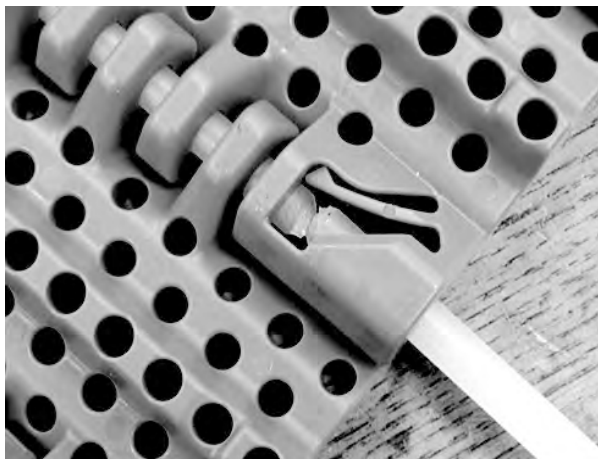
Figuur 85: Duw de scharnierpen tot in de scharnierpenborging
