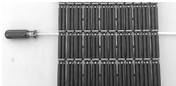
Figuur 243: De scharnierpen uit de band duwen
