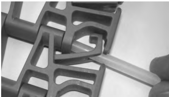
Figuur 246: De scharnierpen in de scharnieren steken
