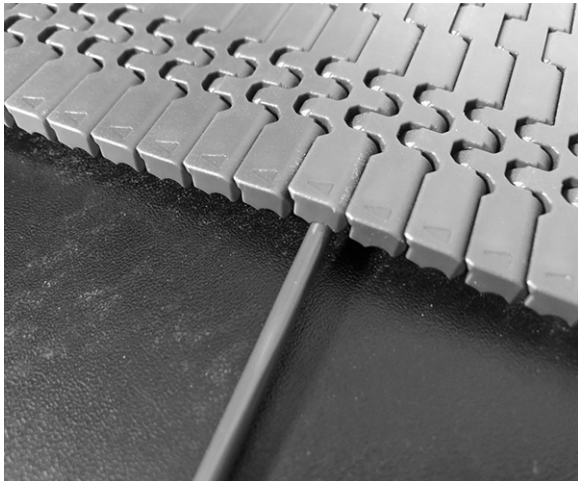
Figuur 58: Scharnieren plaatsen
