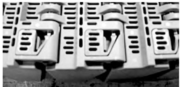
Figuur 105: Controleren of de scharnierpenborging is gesloten
