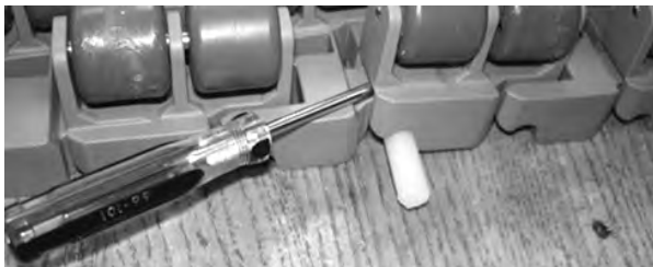
Figuur 195: Scharnierpen uit band trekken
