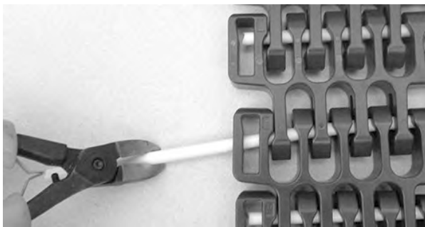
Figuur 317: Scharnierpen uit band trekken
