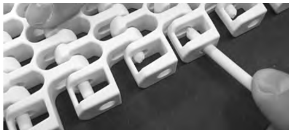
Figuur 287: De scharnierpenen in de scharnieren steken
