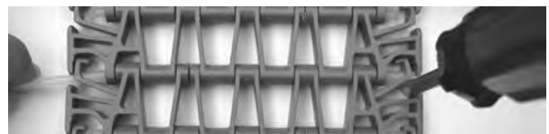
Figuur 250: De scharnierpen uit de band duwen
