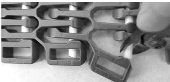
Figuur 328: De scharnierpen vastpakken
