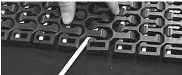
Figuur 304: De scharnierpen in de scharnieren steken
