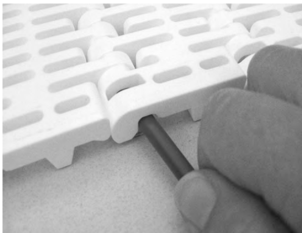
Figuur 79: De scharnierpen in de band duwen
