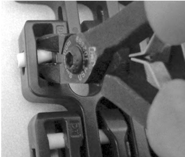
Figuur 316: De scharnierpen opzij duwen, voorbij de opening
