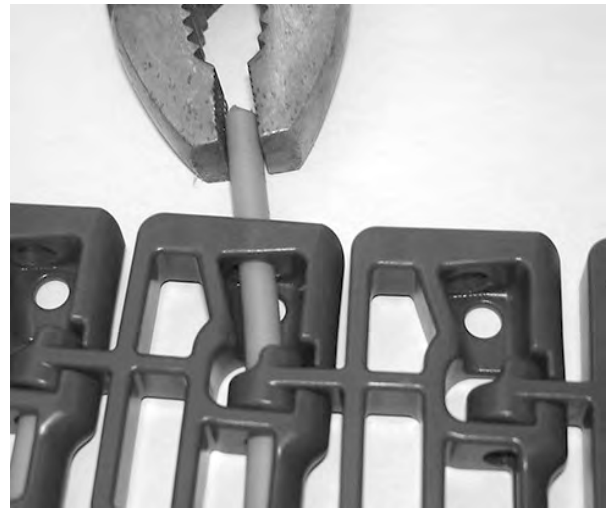
Figuur 126: Scharnierpen uit band trekken
