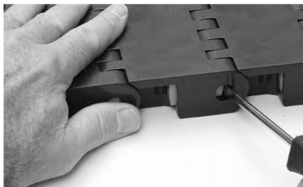
Figuur 262: De Slidelox openen
