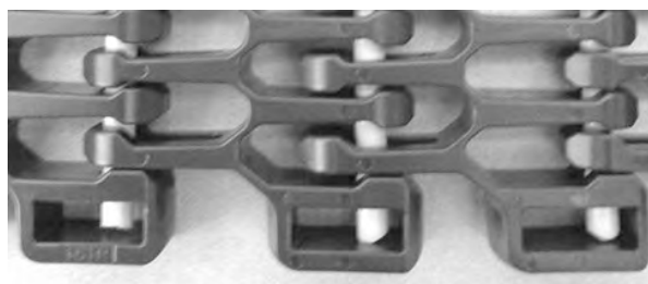
Figuur 326: Controleren of de scharnierpen zich volledig in de band bevindt
