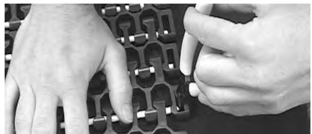
Figuur 309: De scharnierpen in de band duwen
