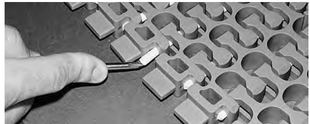
Figuur 271: Controleren of de scharnierpen in de scharnierpenborging zit
