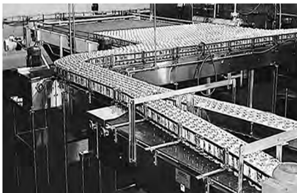
Figuur 17: De steunen over de breedte van de band plaatsen
