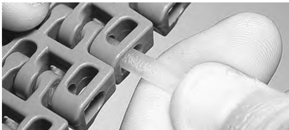
Figuur 144: De scharnierpen in de scharnieren steken
