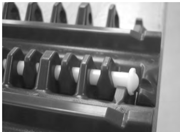
Figuur 70: Controleren of de scharnierpen in de scharnierpenborging zit
