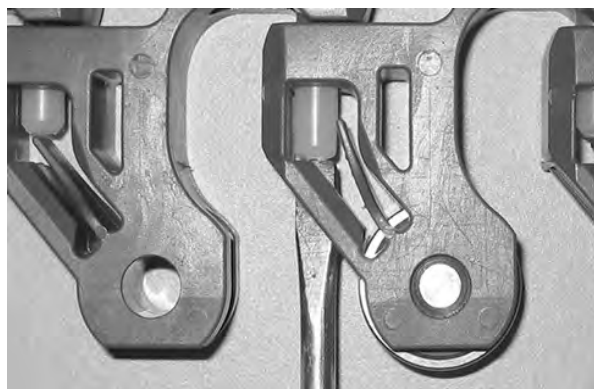
Figuur 300: Duw de scharnierpen tot in de scharnierpenborging
