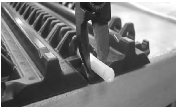
Figuur 72: Scharnierpen uit band trekken
