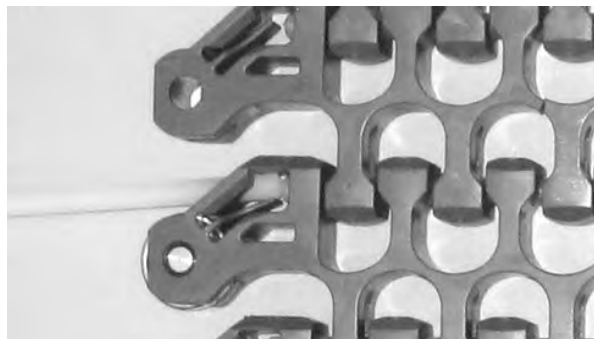
Figuur 299: Scharnierpen uit band trekken
