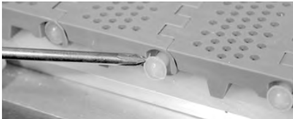
Figuur 63: De scharnierpen in de band duwen
