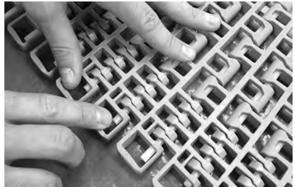
Figuur 339: Controleren of de scharnierpen in de scharnierpenborging zit
