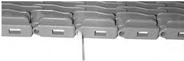
Figuur 41: Breng de scharnierpen in
