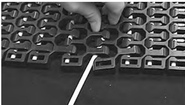
Figuur 305: De scharnieren uitlijnen
