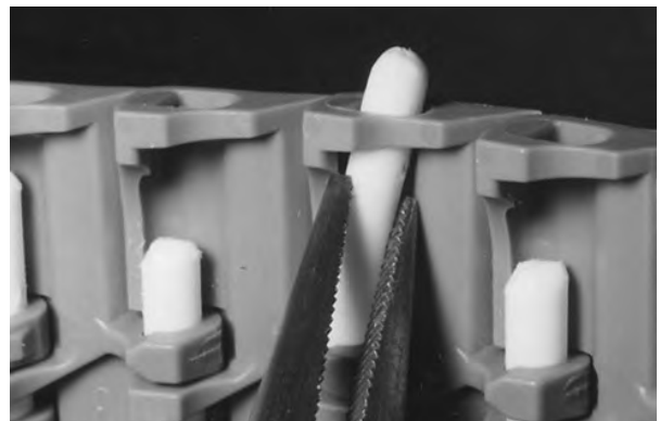
Figuur 148: Duw de scharnierpen tot in de scharnierpenborging
