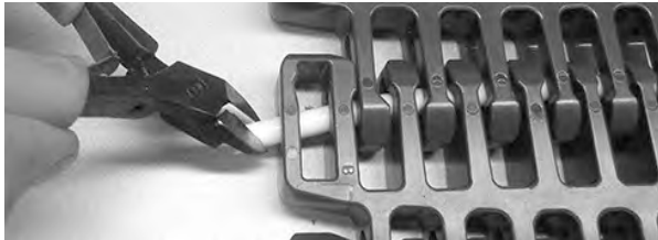
Figuur 334: Scharnierpen uit band trekken
