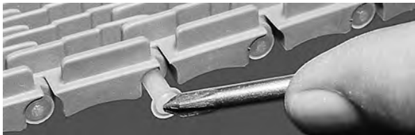
Figuur 22: De scharnierpen in de band duwen
