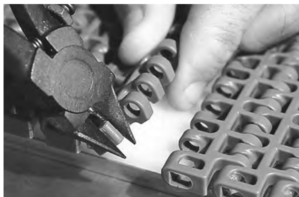
Figuur 142: De rand van de band knippen
