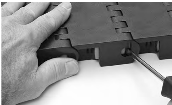
Figuur 260: De Slidelox openen
