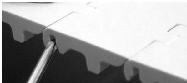
Figuur 204: De scharnierpen tot in de scharnierpenborging duwen
