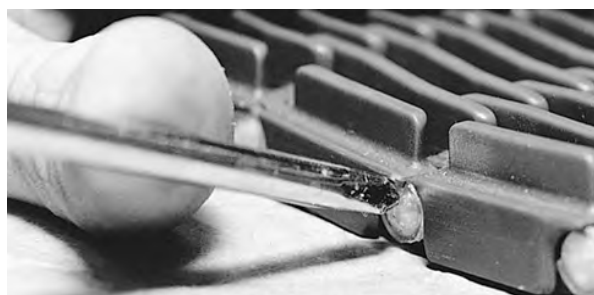
Figuur 112: De scharnierpen voorbij het snapslot duwen
