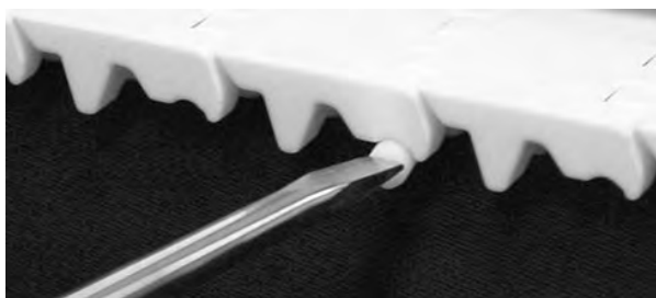
Figuur 174: Duw de scharnierpen tot in de scharnierpenborging
