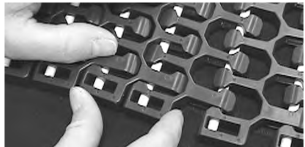
Figuur 308: Controleren of de scharnierpen zich volledig in de band bevindt
