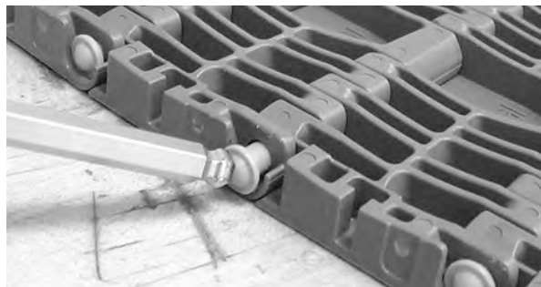
Figuur 267: De borgpen tot in de scharnierpenborging duwen
