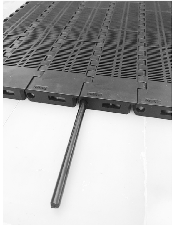
Figuur 210: Scharnieren plaatsen
