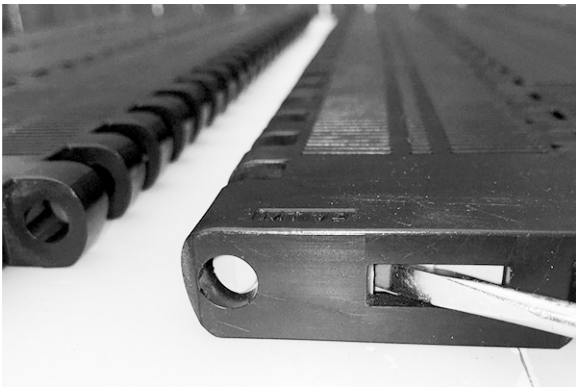
Figuur 209: De Slidelox sluiten met een schroevendraaier
