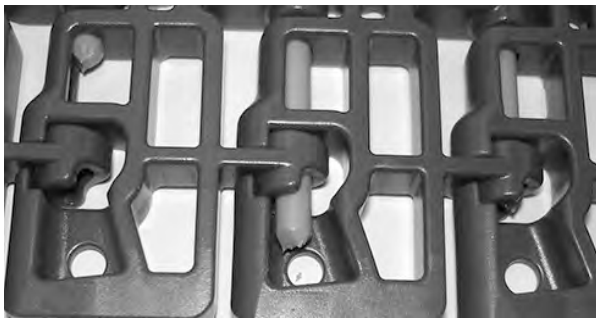
Figuur 124: Controleren of de scharnierpen zich volledig in de band bevindt
