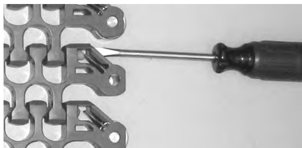
Figuur 298: Scharnierpenborging openen
