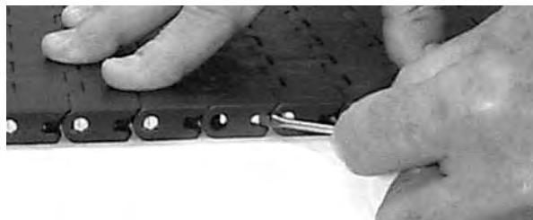
Figuur 165: De Slidelox sluiten
