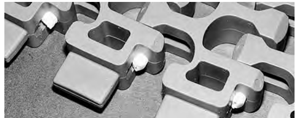
Figuur 272: Controleren of de scharnierpen zich volledig in de band bevindt
