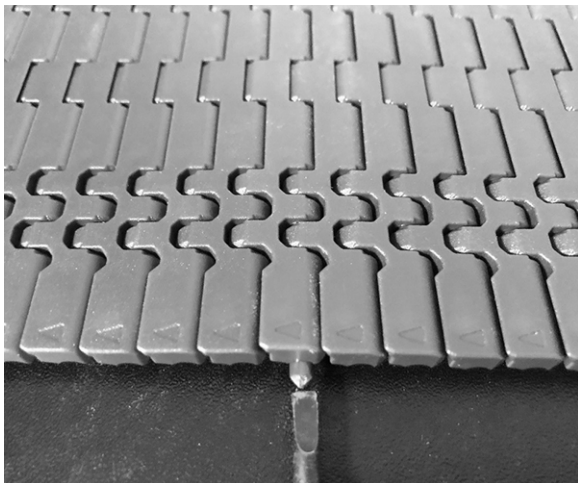
Figuur 59: Scharnieren tot in scharnierenborging duwen
