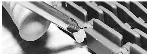
Figuur 111: De scharnierpen in de band duwen
