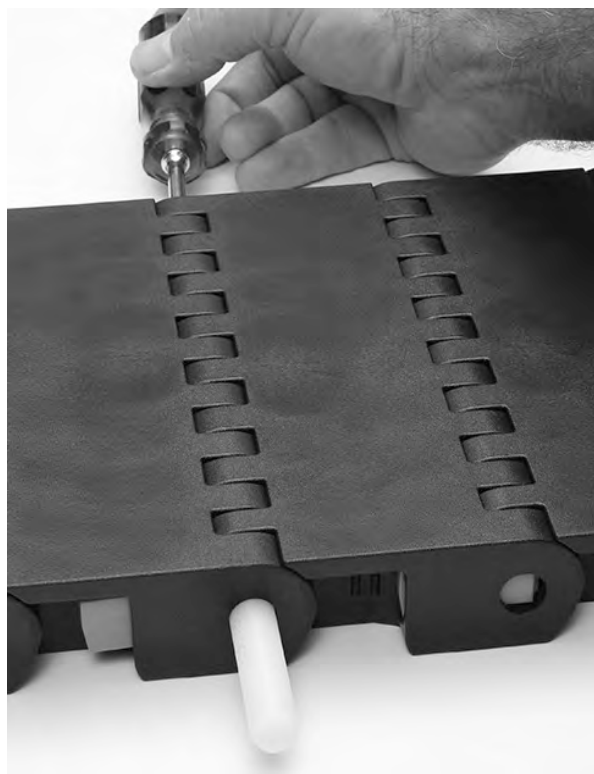
Figuur 263: De scharnierpen uit de band duwen
