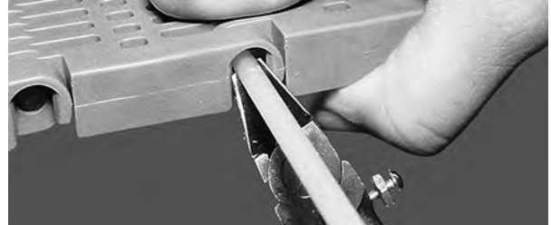
Figuur 39: De scharnierpen snijden zodat deze op gelijke lijn ligt met de rand van de band
