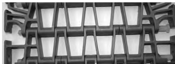
Figuur 255: Controleren of de scharnierpen in de scharnierpenborging zit
