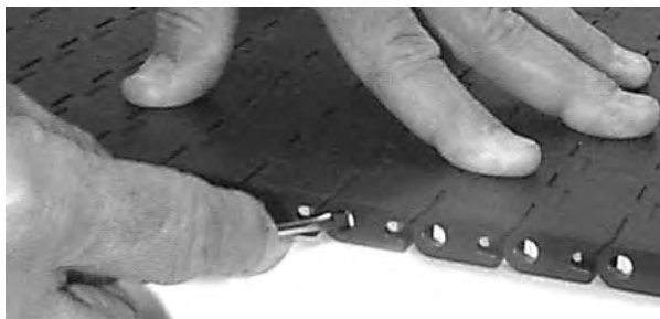
Figuur 163: De Slidelox openen
