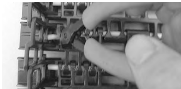
Figuur 353: Scharnierpen uit band trekken
