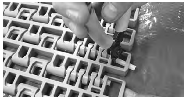
Figuur 340: Scharnierpen uit band trekken
