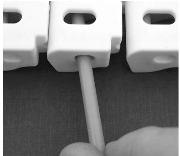
Figuur 286: Scharnierpen uit band trekken
