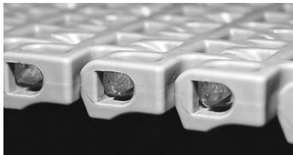
Figuur 137: Controleren of de scharnierpen in de scharnierpenborging zit
