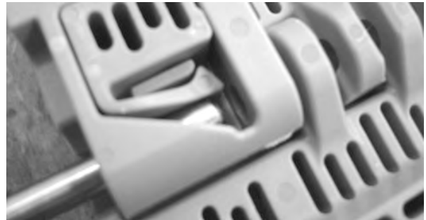
Figuur 103: De scharnierpen in de scharnieren steken
