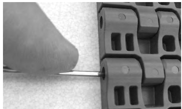
Figuur 130: De scharnierpen voorbij de rand van de band duwen
