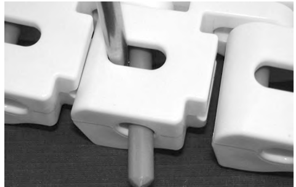
Figuur 285: De scharnierpen tot in de scharnierpenborging duwen
