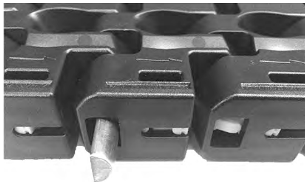
Figuur 199: Bregel de scharnierpen in
