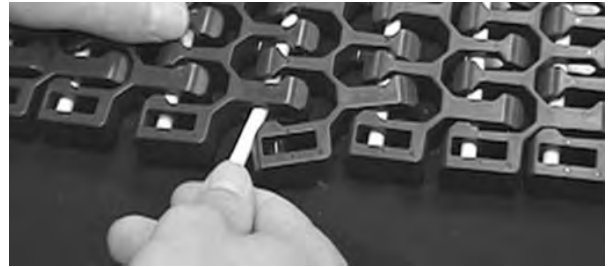
Figuur 306: De scharnierpen in de scharnieren steken
