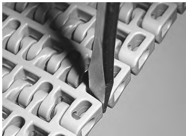
Figuur 138: Duw de scharnierpen tot in de scharnierpenborging
