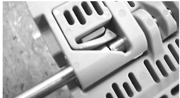
Figuur 104: Duw de scharnierpen tot in de scharnierpenborging
