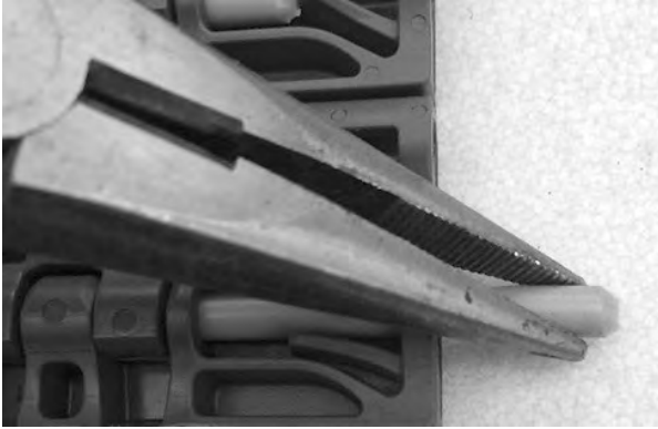
Figuur 131: Scharnierpen uit band trekken
