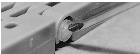
Figuur 38: De kop van de scharnierpen voorbij het snapslot duwen
