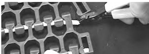
Figuur 311: De scharnierpen vastpakken
