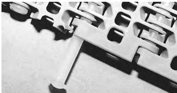
Figuur 28: Breng de scharnierpen in
