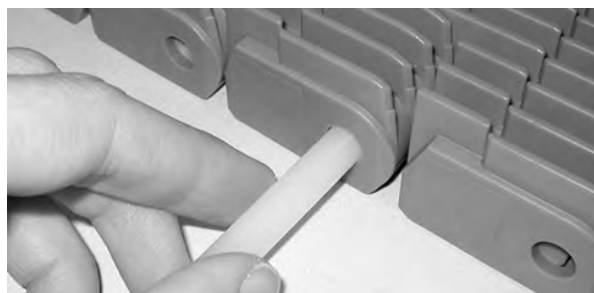
Figuur 218: Scharnierpen uit band trekken
