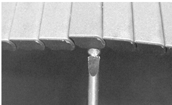
Figuur 54: De scharnierpen tot in de scharnierpenborging duwen
