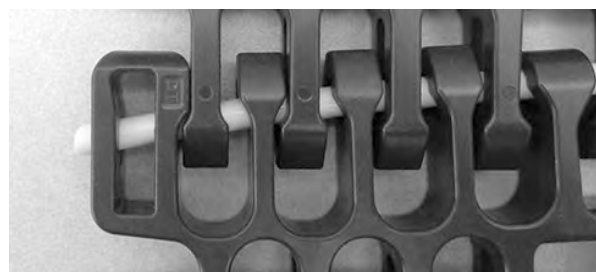
Figuur 314: Duw de scharnierpen tot in de scharnierpenborging
