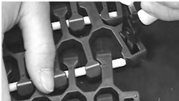
Figuur 310: De vlakke rand van de module buigen om de scharnierpen los te maken
