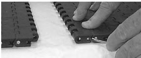
Figuur 162: De Slidelox sluiten
