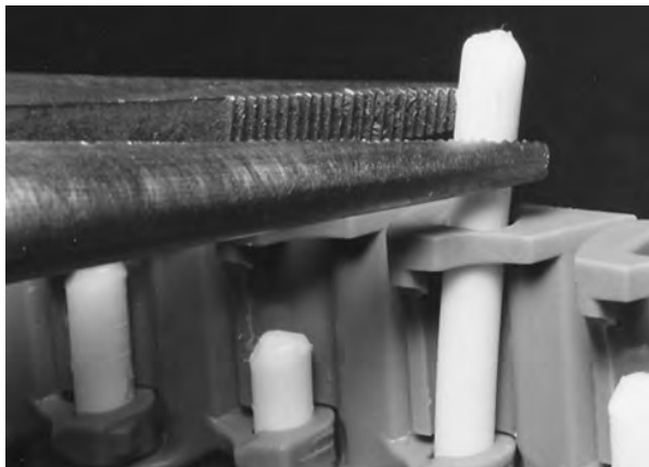
Figuur 149: Scharnierpen uit band trekken
