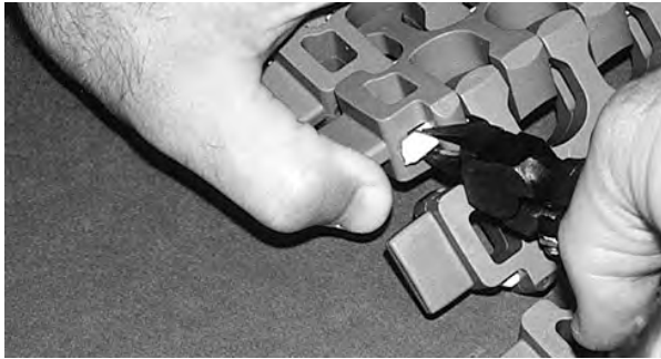
Figuur 273: Scharnierpen uit scharnierpenborging verwijderen
