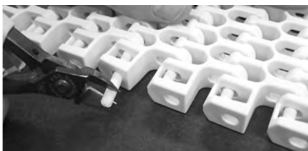
Figuur 291: Scharnierpen uit band trekken
