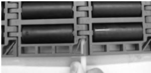
Figuur 236: De scharnierpen in de scharnieren steken
