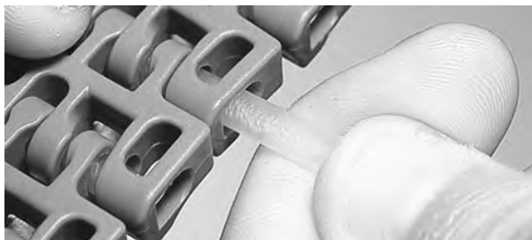
Figuur 135: De scharnierpen in de scharnieren steken
