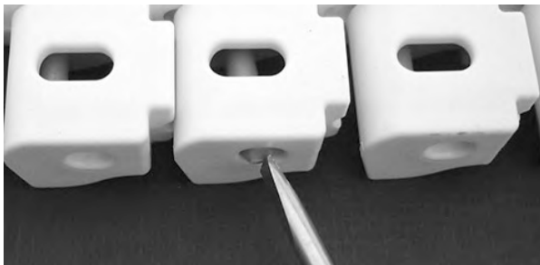
Figuur 283: Duw de scharnierpen tot in de scharnierpenborging
