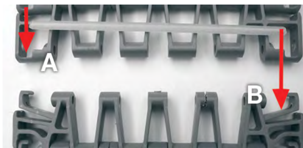
Figuur 251: De scharnierpenborgingen zoeken
