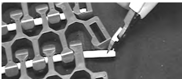
Figuur 312: Scharnierpen uit band trekken
