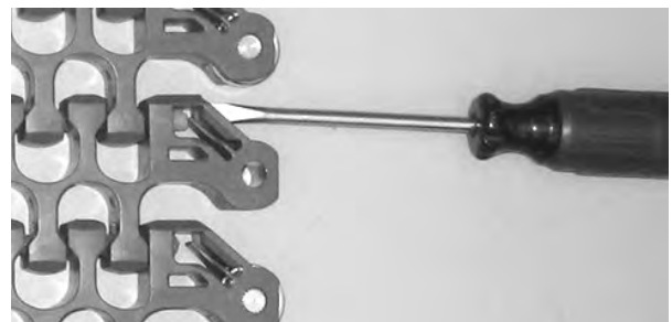
Figuur 280: Scharnierpenborging openen
