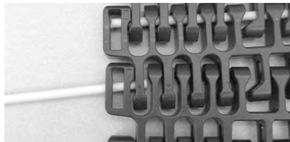
Figuur 313: Breng de scharnierpen in
