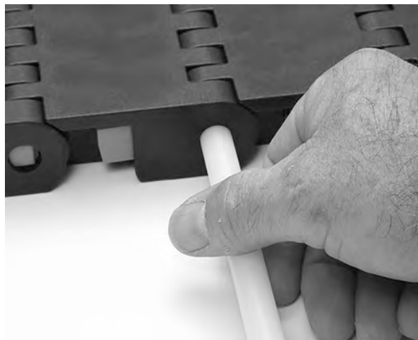
Figuur 258: Breng de scharnierpen in
