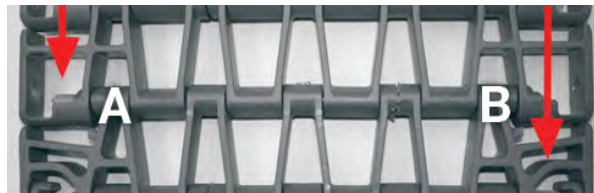
Figuur 253: Controleren of de scharnierpen zich volledig in de band bevindt
