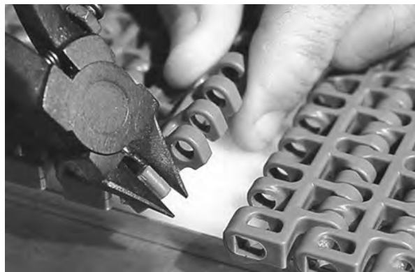
Figuur 152: De rand van de band knippen
