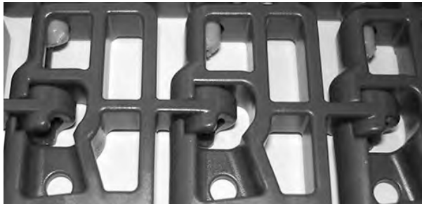
Figuur 116: De scharnierpennen bewegen in de vlakke zijkant
