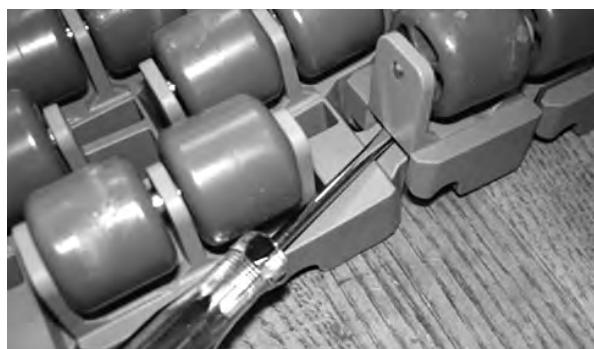
Figuur 192: De schroevendraaier onder de rol steken
