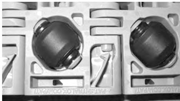
Figuur 226: Controleren of de scharnierpen in de scharnierpenborging zit
