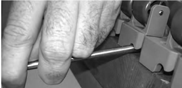
Figuur 193: Een stalen pen door het scharnier steken
