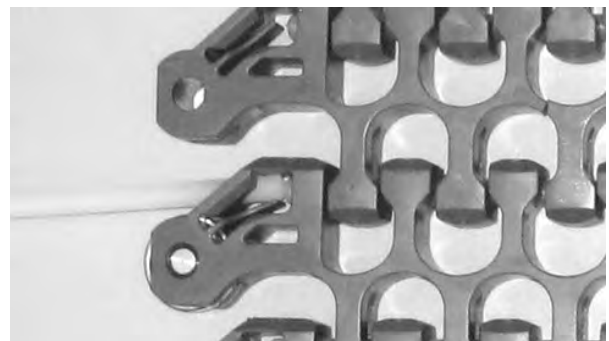
Figuur 281: De scharnierpen uit de band duwen
