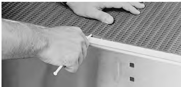
Figuur 15: Breng de scharnierpen in
