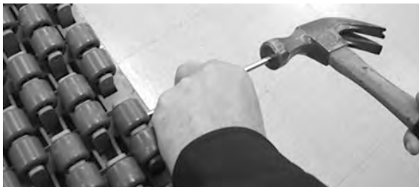
Figuur 194: De scharnierpen uit de band duwen
