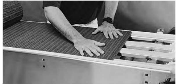
Figuur 8: Band invoeren vanaf de aandrijfzijde
