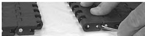
Figuur 160: De Slidelox sluiten met een schroevendraaier
