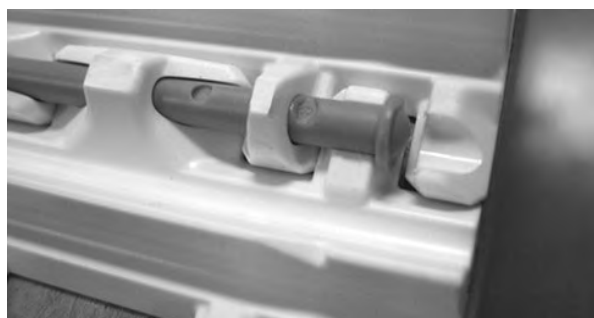
Figuur 181: Controleren of de scharnierpen zich volledig in de band bevindt
