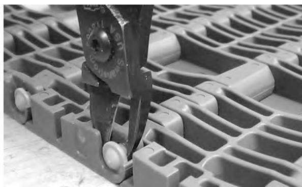
Figuur 268: Scharnierpennetje snijden
