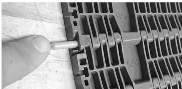
Figuur 266: Breng de scharnierpen in
