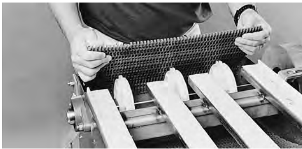
Figuur 11: De band langs het retourpad voeren
