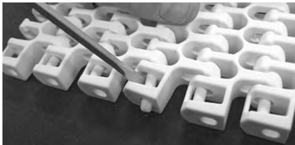
Figuur 290: De scharnierpen tot in de scharnierpenborging duwen
