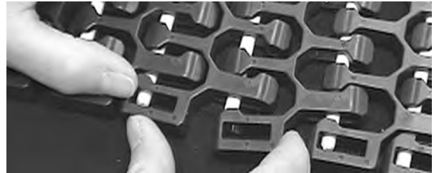
Figuur 307: De scharnierpen voorbij de rand van de band duwen, de vlakke rand over de pen klikken
