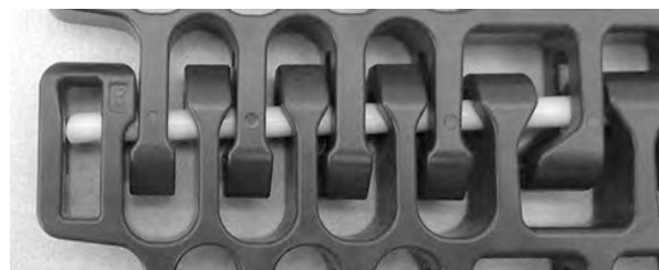
Figuur 315: Controleren of de scharnierpen in de scharnierpenborging zit
