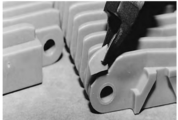
Figuur 47: Buitenste ribbel knippen
