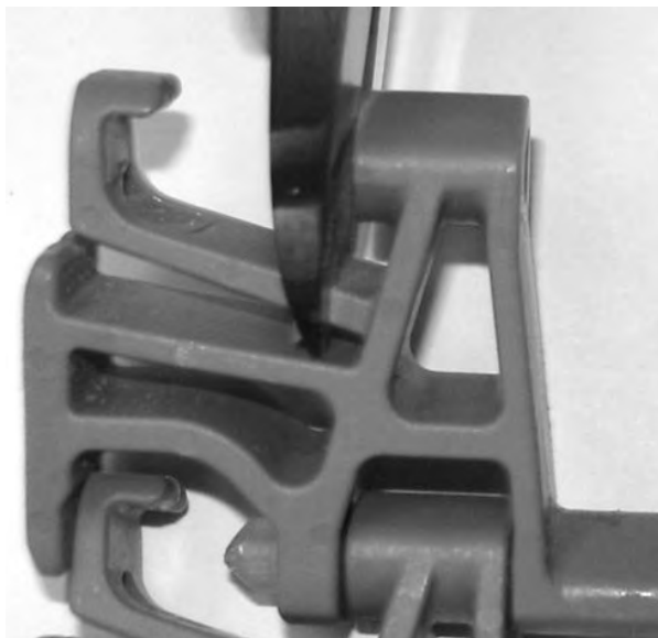
Figuur 252: Scharnierpenborging snijden
