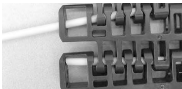
Figuur 354: De scharnierpen in de scharnieren steken
