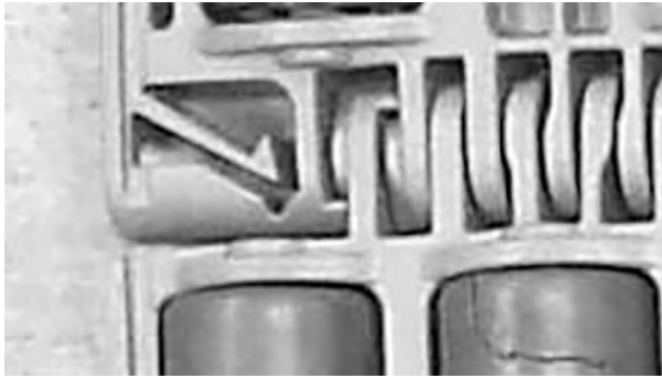
Figuur 223: Controleren of de scharnierpen in de scharnierpenborging zit
